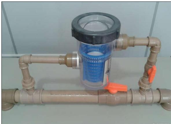
**Figura 7 – Clorador para poço.**
